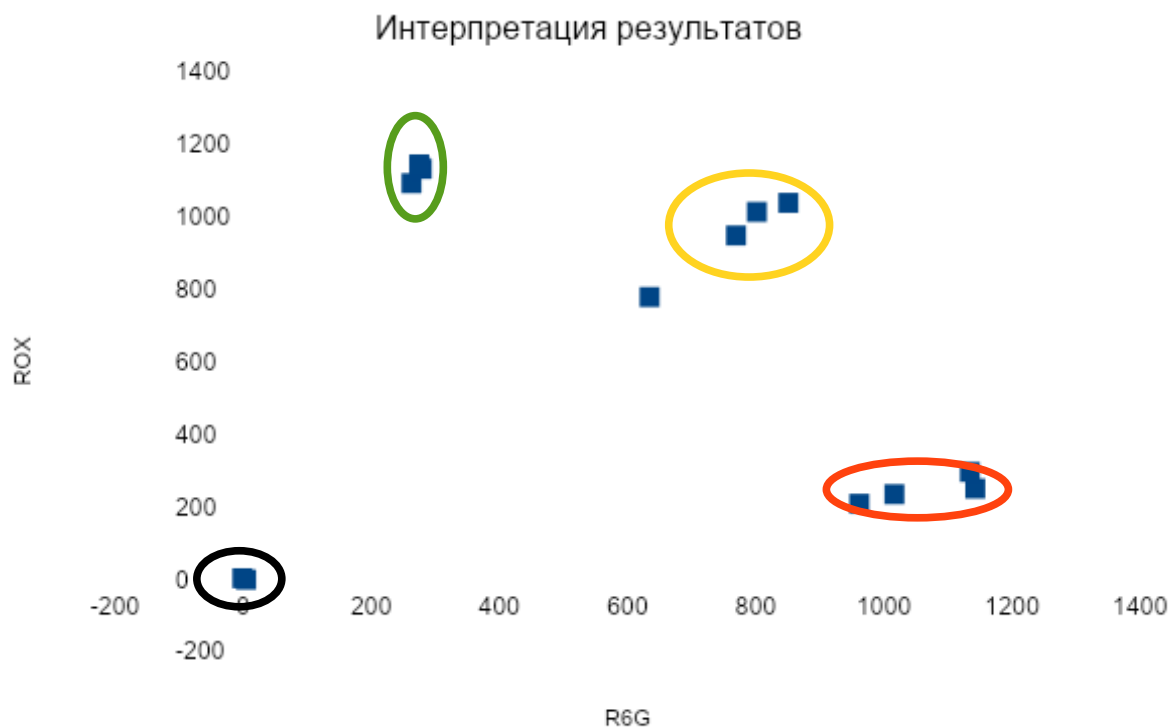
Рисунок 5. Пример кластеризации образцов ДНК на результатах запуска тест-системы. Зеленым выделены образцы с диким типом, желтым – гетерозиготы, красным – пациенты SOPH, черным – вода. Значения флуоресценции приведены в ОЕФ (относительных единицах флуоресценции).
